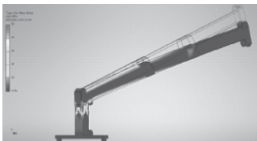
Hình 6. Tổng thể ứng suất phân bố trên kết cấu thép các đoạn ống lồng
