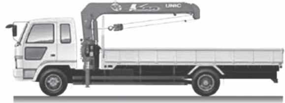
Hình 1. Tổng quan kết cấu ô tô lắp thêm bộ cần trục
