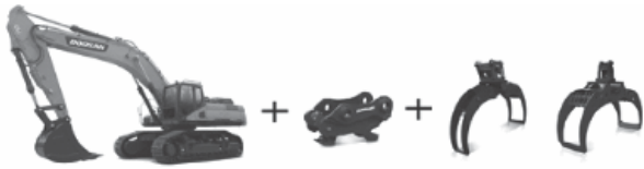
Hình 2. Bộ kẹp gấp gỗ thường lắp trên máy đào cùng bộ tháo lắp nhanh
