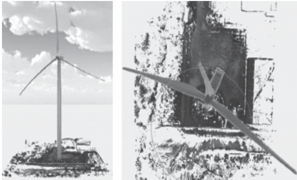
a) Hình chiếu đứng b) Hình chiếu bằng Hình 7. Đám mây điểm thu được bằng TLS
