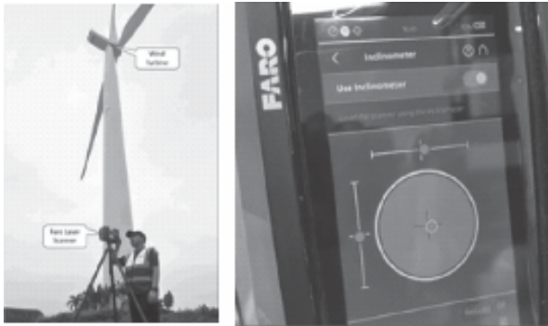
Hình 4. Thiết lập máy quét laser để đo biến dạng tháp tuabin gió tại hiện trường
